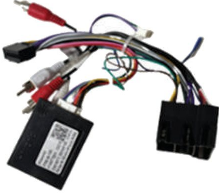
كابل الطاقة مع وحدة CAN-bus (علبة سوداء)
