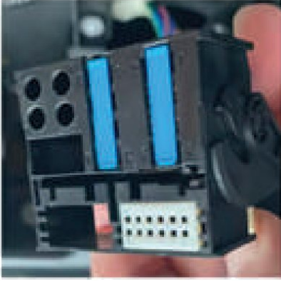
قابس السيارة الأصلي: قارن الشكل وترتيب الدبابيس والقفل.
