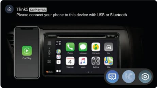
Verbindungsbildschirm mit CarPlay als Beispiel. Unten rechts wählen Sie den Modus; oben steht „CarPlay/AA“, wenn der richtige Modus aktiv ist.
