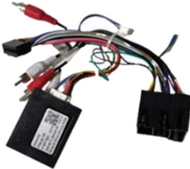
Stromkabel mit CAN-Bus-Modul (schwarzes Kästchen)
