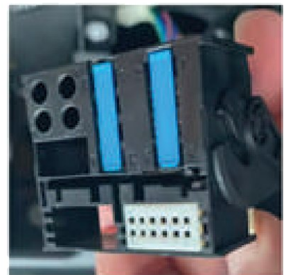
Originaler Fahrzeugstecker: Vergleichen Sie Form, Pinbelegung und Verriegelung.
