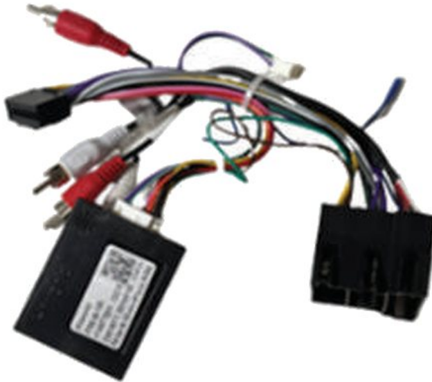
Cable de alimentación con módulo CAN-bus (cajita negra)
