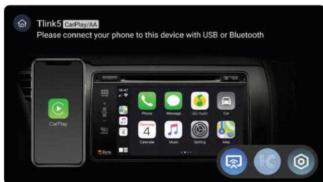
Pantalla de conexión con CarPlay como ejemplo. Abajo a la derecha se elige el modo; en la parte superior aparece "CarPlay/AA" cuando el modo correcto está activo.
