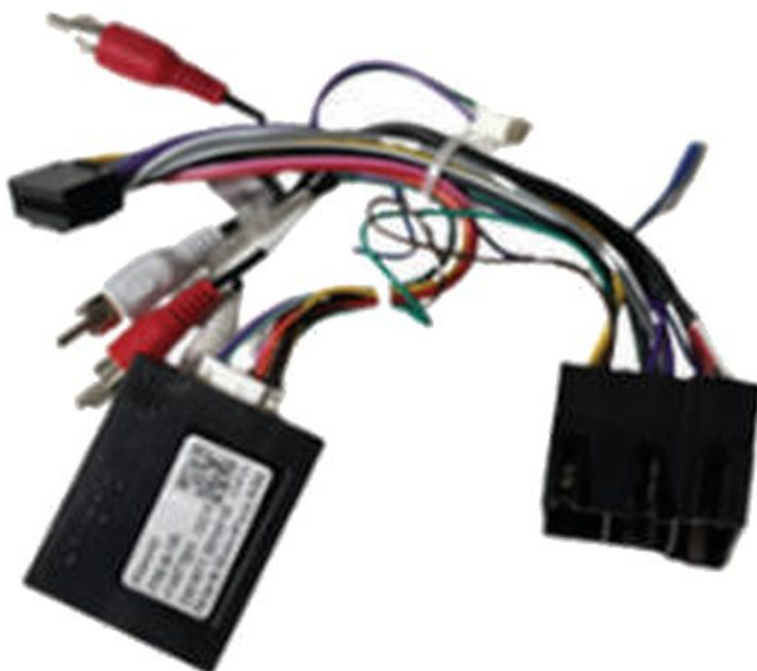
Câble d'alimentation avec module CAN-bus (boîtier noir)
