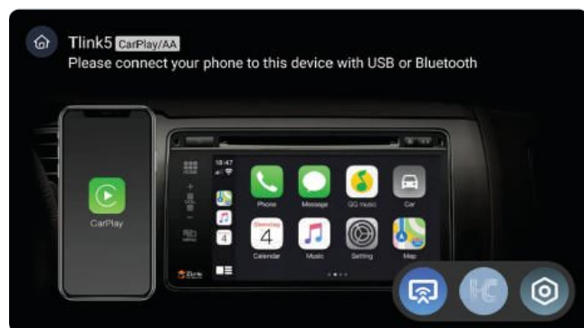
Écran de connexion avec CarPlay en exemple. Le mode se choisit en bas à droite ; « CarPlay/AA » s'affiche en haut lorsque le bon mode est actif.
