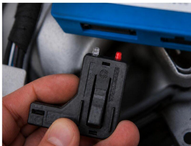
Stap 2: stekker plaatsen in de Cartronix decoderbox.
