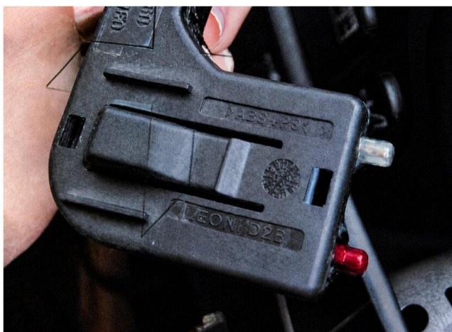
Stap 1: originele D2B-stekker loskoppelen.
