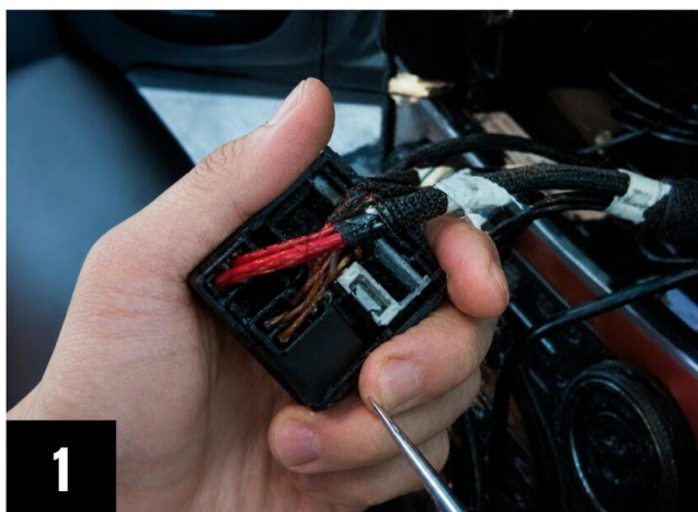
Stap 2: connector losmaken uit de originele bekabeling.
